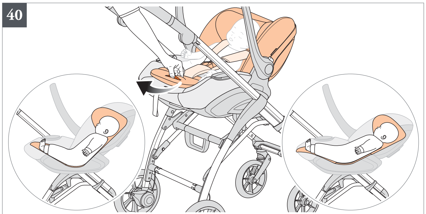
fig. 40 Quando è montato sul telaio, il seggiolino auto può essere reclinato per consentire al bambino la migliore posizione anche durante la passeggiata.
